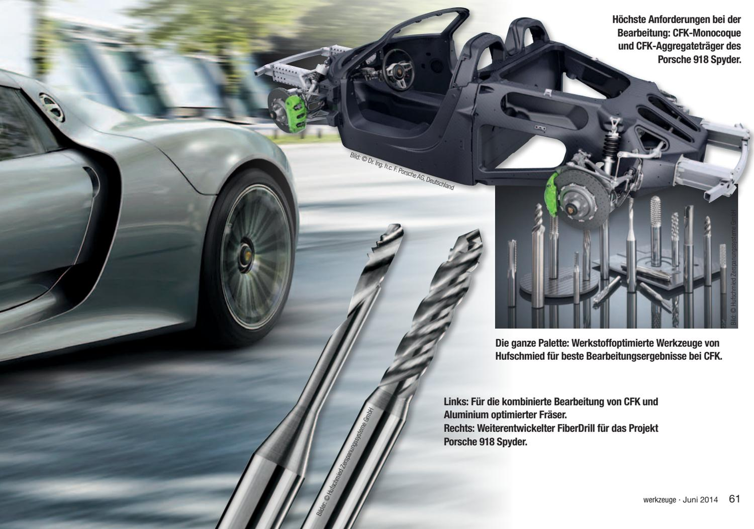
**Höchste Anforderungen bei der Bearbeitung: CFK-Monocoque und CFK-Aggregateträger des Porsche 918 Spyder.**
